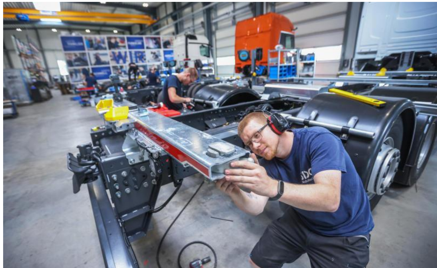
Frank Wins (vorne) montiert an das Fahrgestell eines Lkw ein Trägersystem für abnehmbare Transportbehälter.
