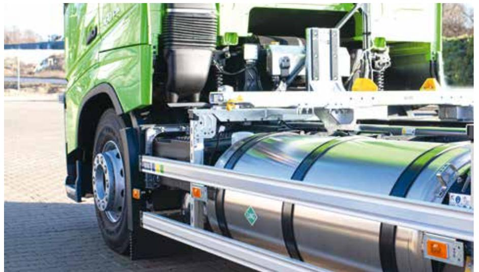
**Passgenau, trotz Erdgastank: SDG-Wechselrahmen beim Volvo FH LNG**
