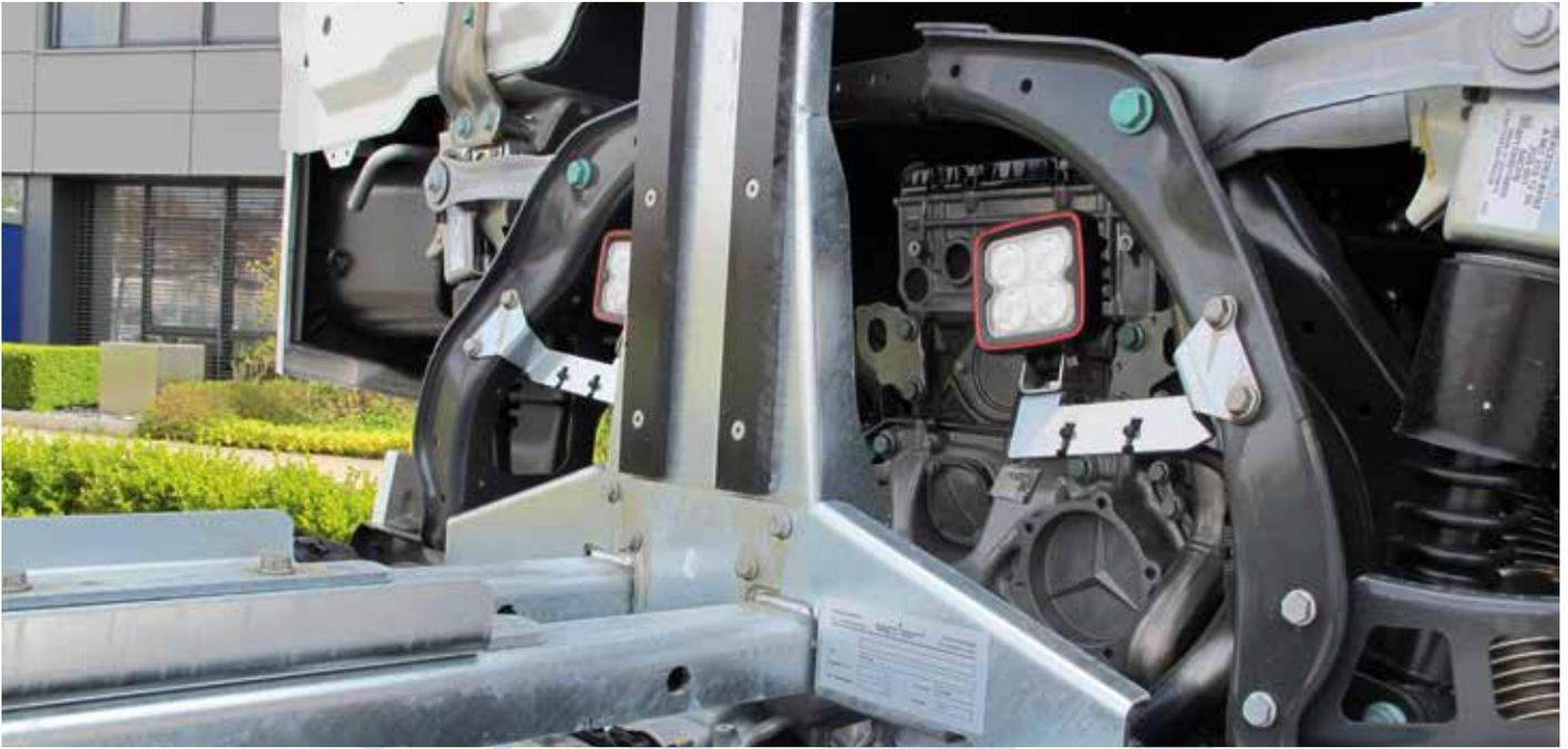
Längsanschlag mit Rahmenabstützung
